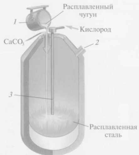
Рис. 22. Кислородный конвертер для выплавки стали: 1 — загрузочный ковш; 2 — выпускное отверстие; 3 — огнеупорная трубка
